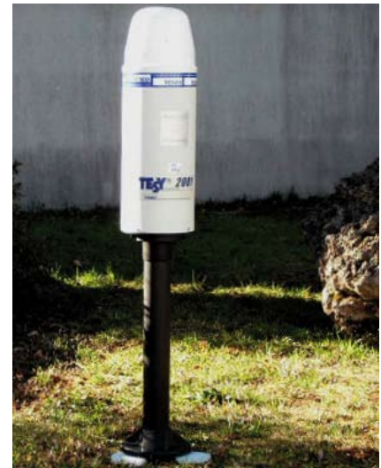
Sonda per misura induzione magnetica in banda larga.
